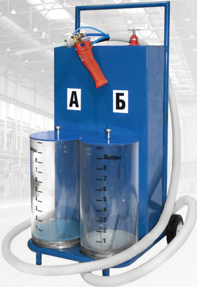
Установка смешивающая **СМ-1** предназначена для смешивания, подачи и напыления двухкомпонентных силиконов и прочих неагрессивных материалов с пропорциями смешивания 1:1. Установка может использоваться при изготовлении силиконовых мешков для вакуумной инфузии, изготовлении матриц и моделей, для заполнения корпусов, нанесения клеев и герметиков.
